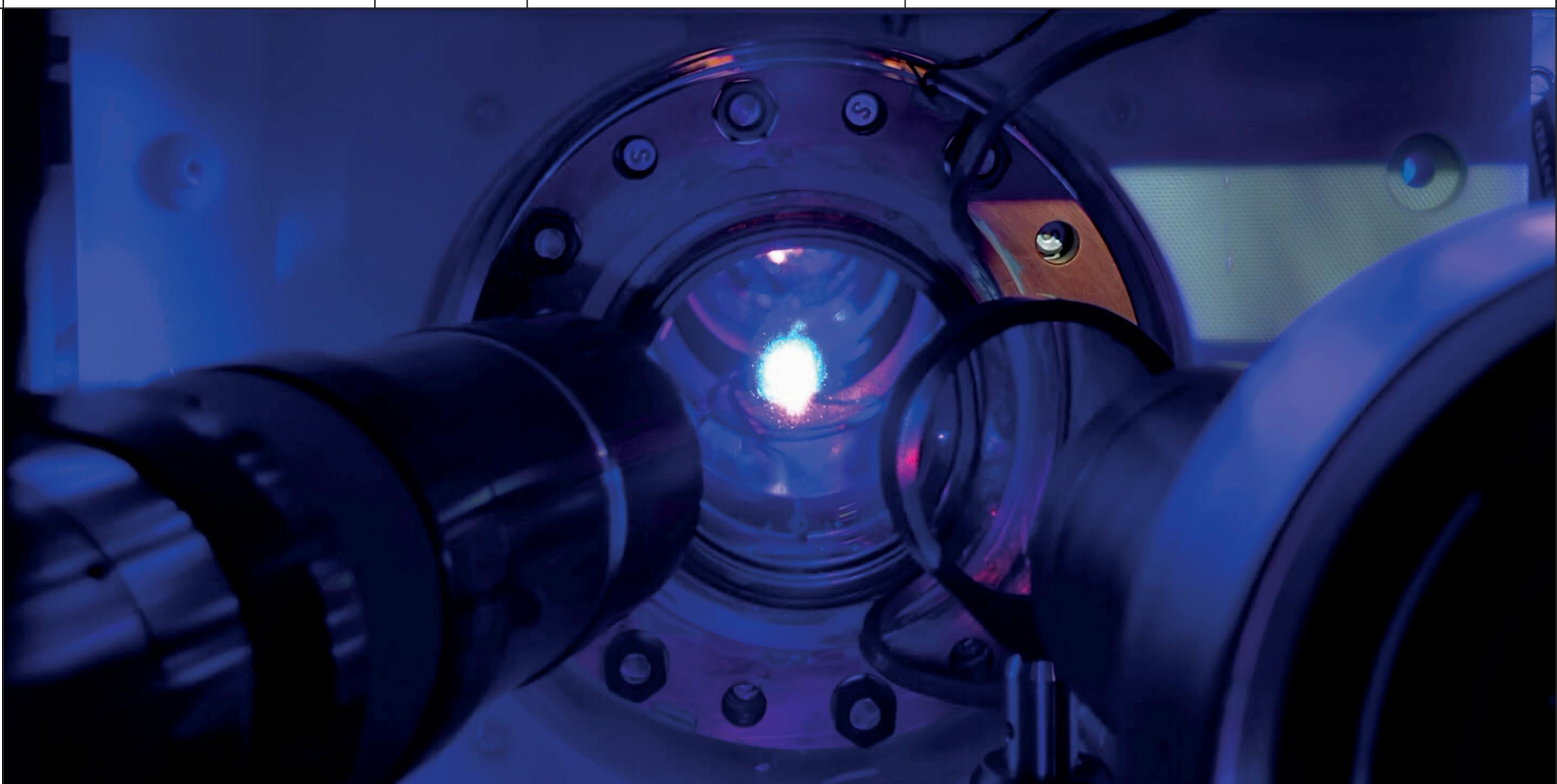
En envoyant un laser ultra-précis sur du strontium, des chercheurs ont créé l'horloge atomique la plus précise au monde. La fréquence du laser est ajustée pour faire sauter un électron de l'atome de strontium entre ses niveaux d'énergie, et l'horloge est ajustée à cette fréquence. Elle mesure alors le temps au milliardième de milliardième de seconde près !
