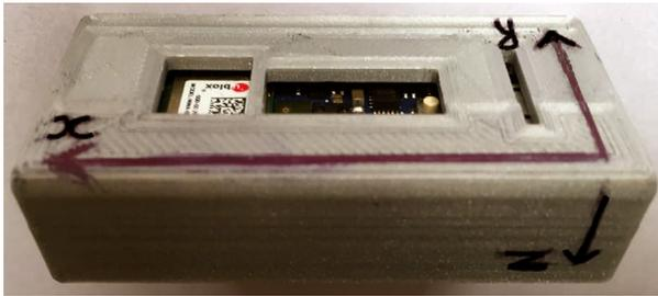
Figure 3 - Les trois axes de l'accéléromètre indiqués sur le boîtier.
