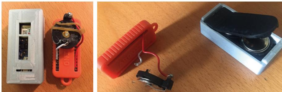
Figure 2 - Différents types de boîtiers et d'alimentation de l'Arduino nano.
