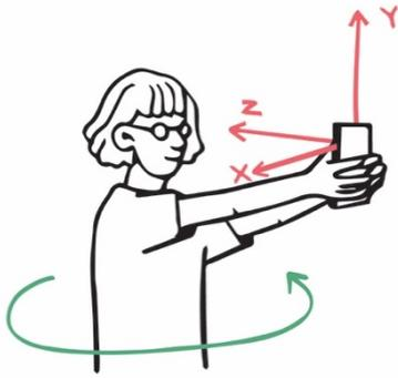
On cherche à étudier un mouvement de rotation à l'aide d'un smartphone. On pourra ainsi tester et exploiter la relation entre la coordonnée normale du vecteur accélération (accélération dite *centripète*) et la vitesse d'un point. Grâce à son gyroscope et son accéléromètre, le smartphone permet de mesurer à la fois les trois coordonnées, dans le référentiel du "laboratoire", de son accélération et sa vitesse angulaire autour de chacun des trois axes.
