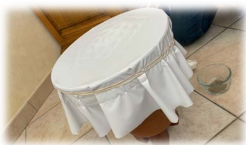
Figure n°2 : Montage pot de fleur. Il est fabriqué à partir d'un pot de fleur, d'une enceinte Bluetooth posée à l'intérieur et d'une membrane plastique.
