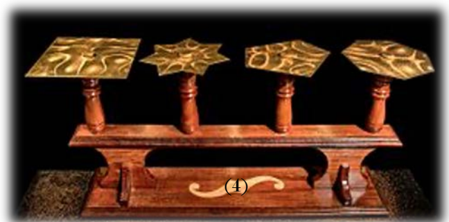
Figure n°4 : Dispositif pour l'étude des figures de Chladni. Cette image provient de la page Wikipédia « Figure de Chladni ».
