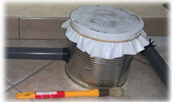
Figure n°1 : Tonoscope maison. Il est fabriqué à partir d'une boîte de conserve, d'un tuyau en PVC et d'une membrane plastique.
