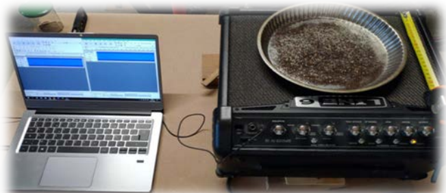
Figure n°3 : Set up du montage enceinte et plaque d'acier. Il comporte une plaque d'acier, posée sur une enceinte. Le son émis est commandé par l'ordinateur
