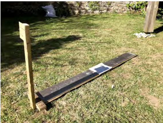
FIGURE 9 – Seconde itération de notre dispositif expérimental. Il s'agit d'un morceau de bois vissé perpendiculairement à un bâti de bois plat. Sur ce morceau de bois vissé on place à une hauteur de 50 cm un morceau de carton rigide dans lequel est percé un trou de diamètre 0.4 cm. Le protocole expérimental ne change pas. Nous avons répété l'expérience toutes les dix minutes pendant 5h30.
