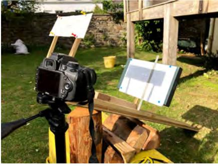
FIGURE 14 – Troisième itération de notre dispositif de mesure (DESIREE 3). On a percé deux trous de diamètre  $d_t = 0.4 \text{ cm}$  dans un morceau de carton. Ces deux trous sont séparés d'une distance  $d = 9 \text{ mm}$ .
