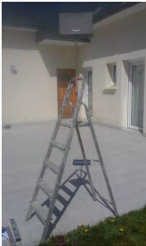
FIGURE 5 – Photo du dispositif (DESIREE 1') utilisé pour la seconde série de mesure. Nous disposons d'une boîte à chaussures percée de 2 trous quadrangulaires de diamètres 0.5 cm et 1 cm, et placée au sommet d'une tige rigide.
