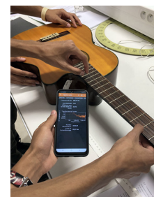
▲ À l'université de Bordeaux, des étudiants utilisent un smartphone afin de mesurer la résonance d'une corde de guitare.
