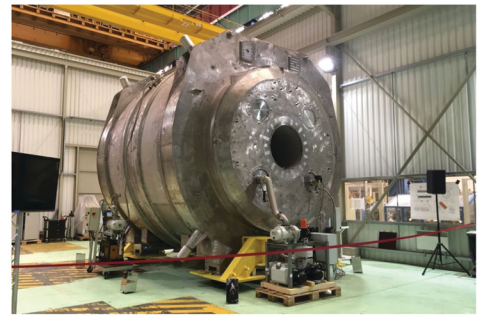
L'aimant IRM du centre de recherche NeuroSpin du CEA Saclay (Essonne) pèse 130 tonnes et produit un champ magnétique de 11,7 teslas. © CEA
