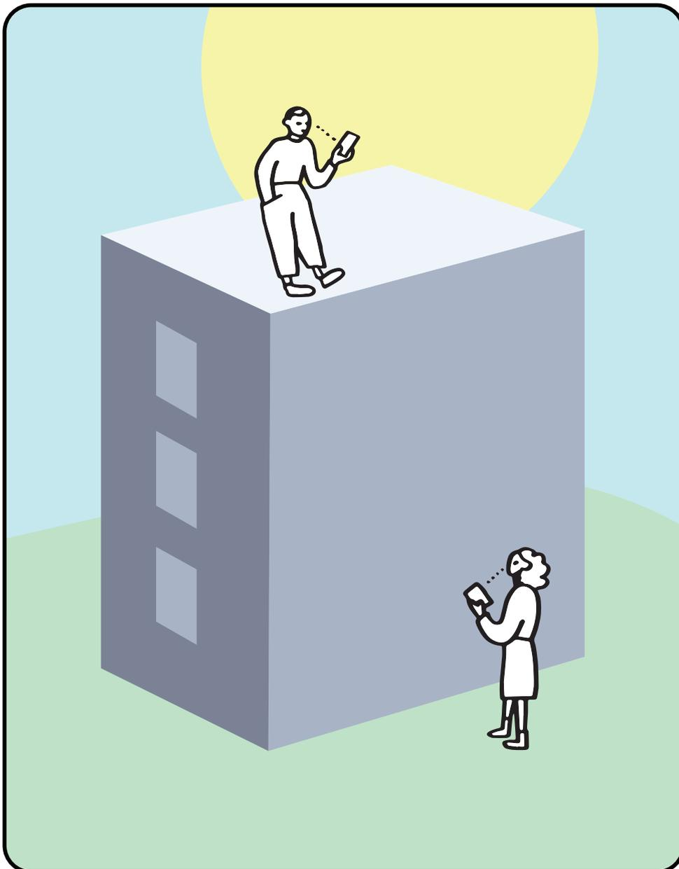
Mesurez la pression atmosphérique en haut et en bas du bâtiment. La variation de pression dépend directement de la hauteur et de la masse volumique de l'air.
